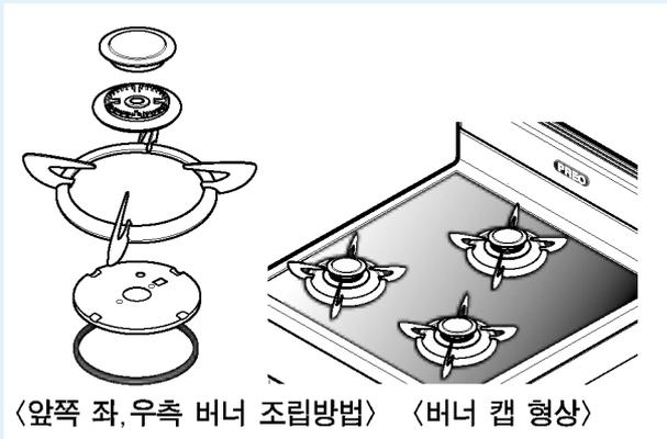
■ 청소 후 버너헤드, 버너캡이 잘못 조립되면 점화시 순간적으로 불꽃이 정상보다 높게 솟아올라 화상이나 화재의 위험이 있으므로 반드시 분해전 상태로 바르게 조립하여 주세요.
