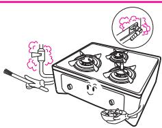
호스는 가스용 고무호스(제조 및 검사 합격표시가 있는 것)을 사용하고, 가스 접속용 고무관은 비눗물을 사용하여 수시로 배관 및 접속부위에 가스가 새는지를 확인하세요.
