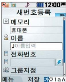
저장 메모리의 위치는 기본적으로 '휴대폰'으로 설정되어 있습니다. 휴대전화의 내장 메모리에 저장하려면 '휴대폰'을 선택하고 USIM 카드 메모리에 저장하려면 'USIM'을 선택하세요.
